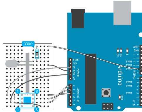
그림 10-2 가속도 센서와 LED를 연결한 배선도. 급격한 움직임을 감지하면 LED가 일정 시간 켜진다.<sup>1</sup>
