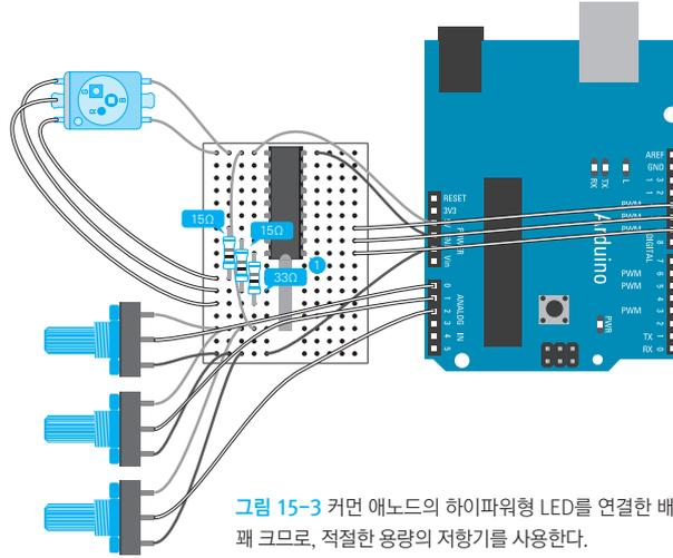
그림 15-3 커먼 애노드의 하이파워형 LED를 연결한 배선도. 하이파워 형은 발열량이 꽤 크므로, 적절한 용량의 저항기를 사용한다.
