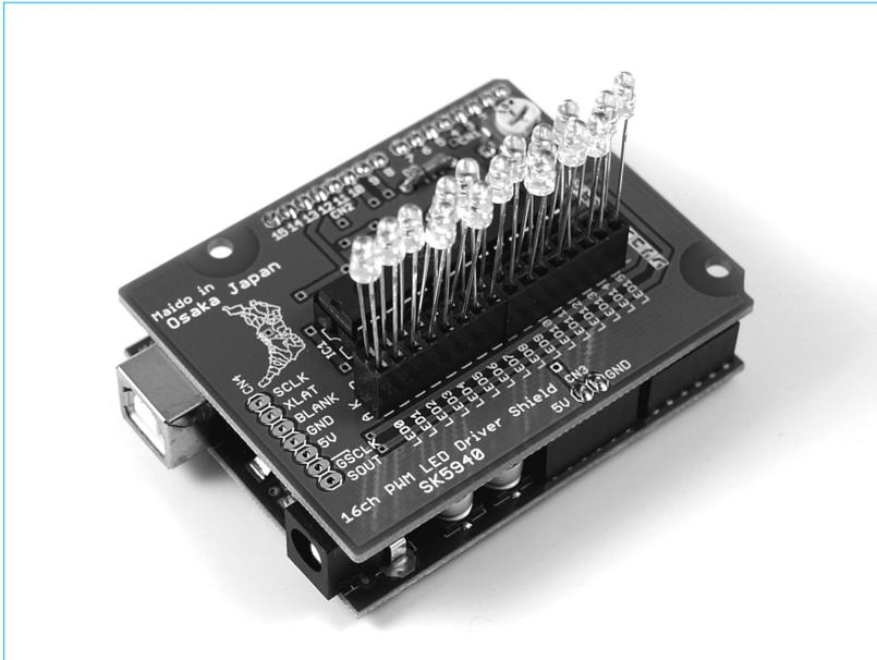
그림 15-4 큐리쓰 전자의 TLC5940 쉴드. 16개의 LED 밝기를 4096 단계로 제어할 수 있다. 아두이노용 라이브러리도 있다 ([URL](http://code.google.com/p/tlc5940arduino) http://code.google.com/p/tlc5940arduino)
